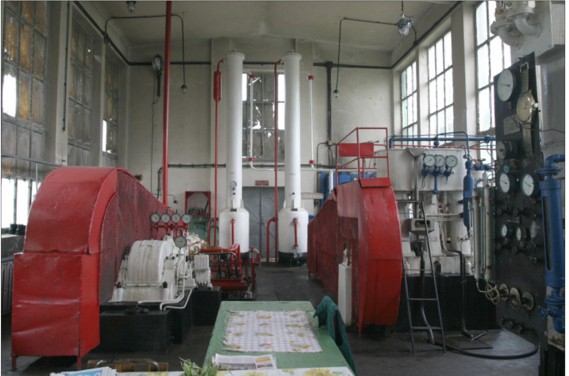
Lindeanlage von 1928: vier-stufiger Kompressor, Verflüssigung und Reinigung
