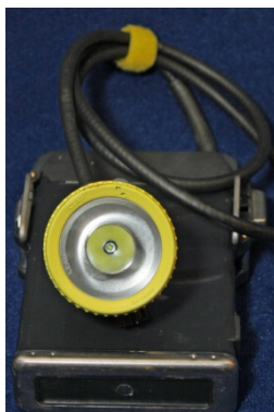
Modul einsetzen, dabei die Kabel durch die Schlitze der Fassung führen und darauf achten, dass die Schaltkontakte nicht beeinflusst werden. Das Modul passt mit der Messingbasis exakt auf den Sitz der Lampenfeder.
