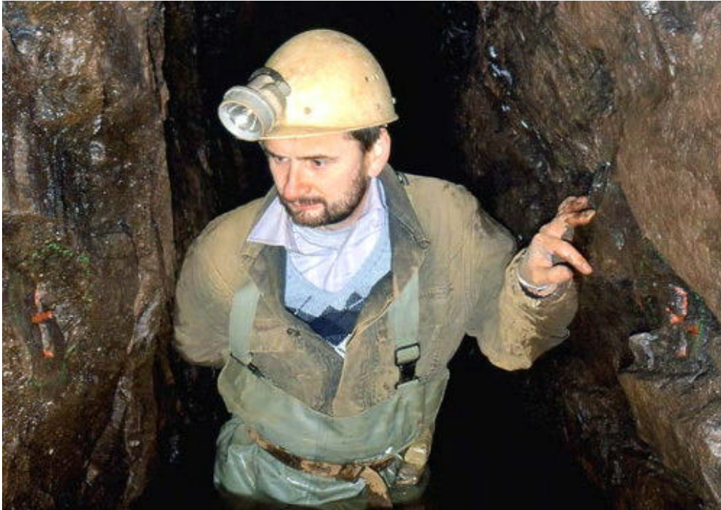
· Bild 2-01: Markscheiderische Zeichen, zwei gegenüber liegende Kreuze. Grubenfeldgrenze, in einem Wasserlösungsstollen der durch mehrere Maaßen geht, Marienberger Revier, Sachsen.
