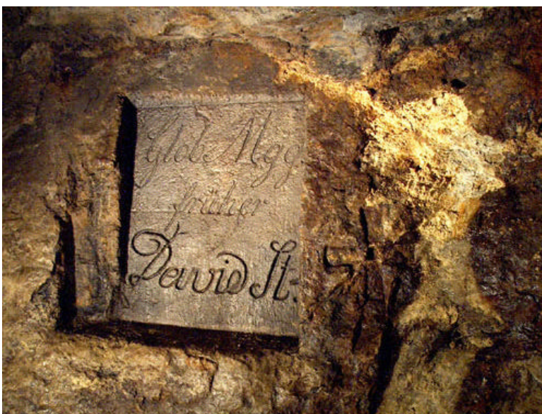
· Bild 3-10: Gangtafel mit Markscheidekreuz, Gottlob Morgengang ehem. David Stehender, Davidschacht, Revier Himmelfahrt Fundgrube, Freiberg, Sachsen.
